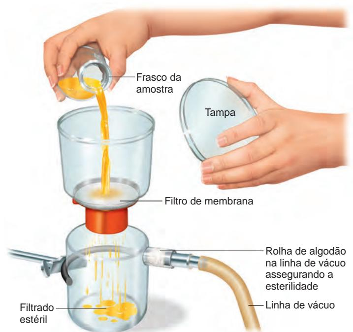
**Figura 7.4** Esterilização com filtro, com uma unidade plástica descartável, pré-esterilizada. A amostra é colocada na câmara superior e forçada através do filtro de membrana pelo vácuo, para a câmara inferior. Os poros do filtro de membrana são menores que as bactérias, e assim, elas são retidas no filtro. A amostra esterilizada pode então ser decantada na câmara inferior. Um equipamento similar com discos de filtro removíveis é usado para contar as bactérias em amostras (veja a Figura 6.18).
