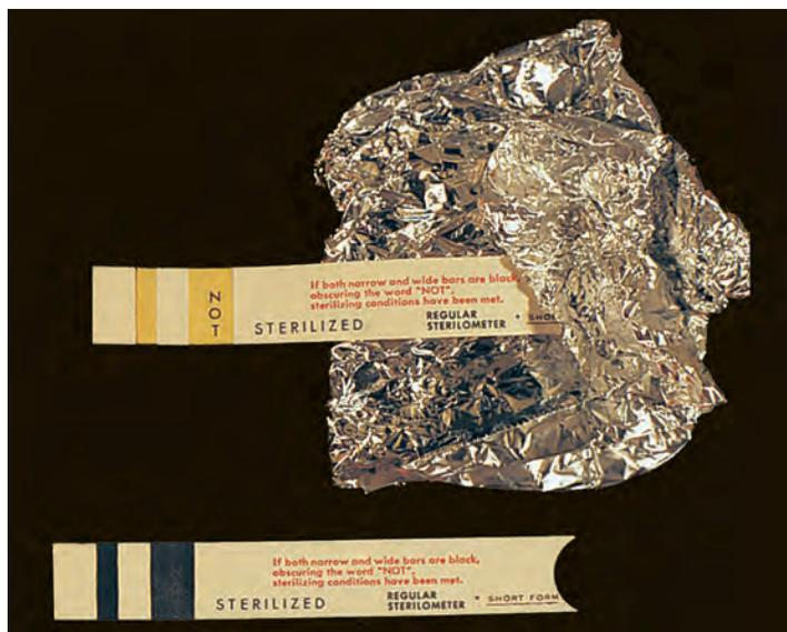
**Figura 7.3 Exemplos de indicadores de esterilização.** As tiras indicam se o item foi esterilizado corretamente; a palavra *NÃO* (*NOT*) aparece se o aquecimento foi inadequado. Na ilustração, o indicador que está envolto na lâmina de papel alumínio não foi esterilizado porque o vapor não conseguiu penetrar na lâmina.
