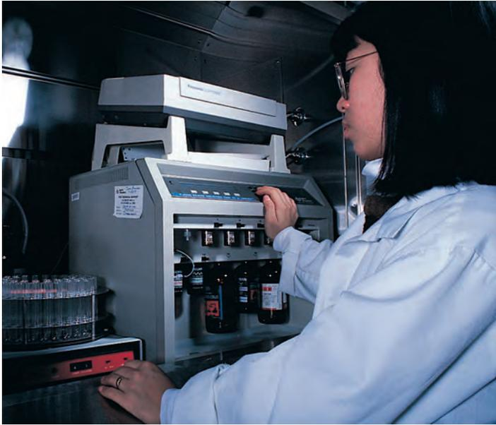
**Figura 9.10** Uma máquina de síntese de DNA. Sequências curtas de DNA podem ser sintetizadas por aparelhos como este.
