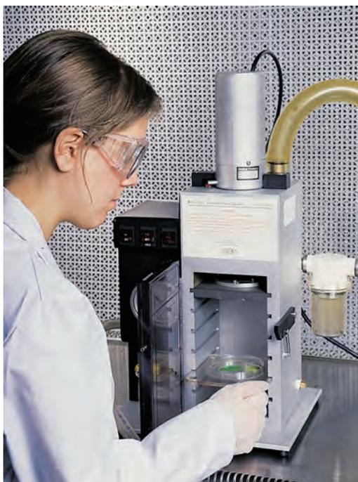
**Figura 9.6** Uma pistola de genes, que pode ser usada para inserir “projéteis” revestidos de DNA em uma célula.
